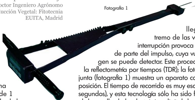
"guía"; al llegar al extremo de las varillas, esa interrupción provoca la reflexión de parte del impulso, cuya vuelta al origen se puede detectar. Este procedimiento es la reflectometría por tiempos (TDR); la fotografía adjunta (fotografía 1) muestra un aparato con esta disposición. El tiempo de recorrido es muy escaso (nanosegundos), y esta tecnología sólo ha sido factible con el desarrollo de la electrónica digital de alta velocidad.
