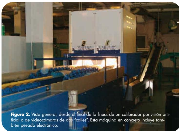
**Figura 2.** Vista general, desde el final de la línea, de un calibrador por visión artificial o de videocámaras de dos "calles". Esta máquina en concreto incluye también pesado electrónico.
